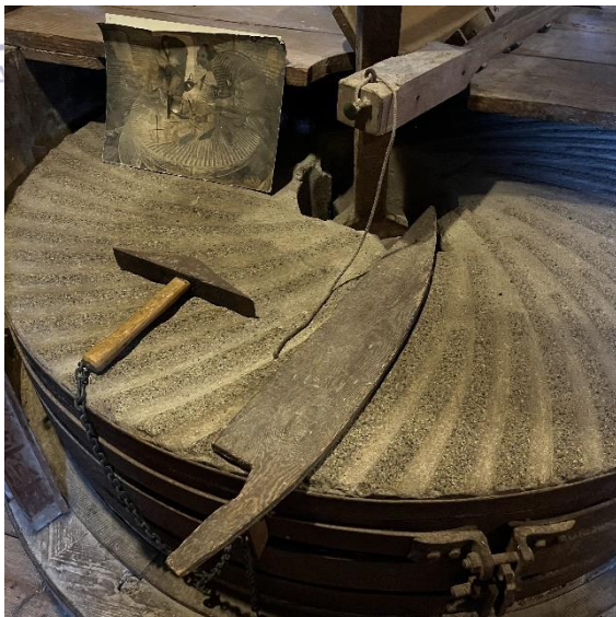
Bilhamer en gereedschap voor ronding groef maalsteen (Molen De Eendracht)
